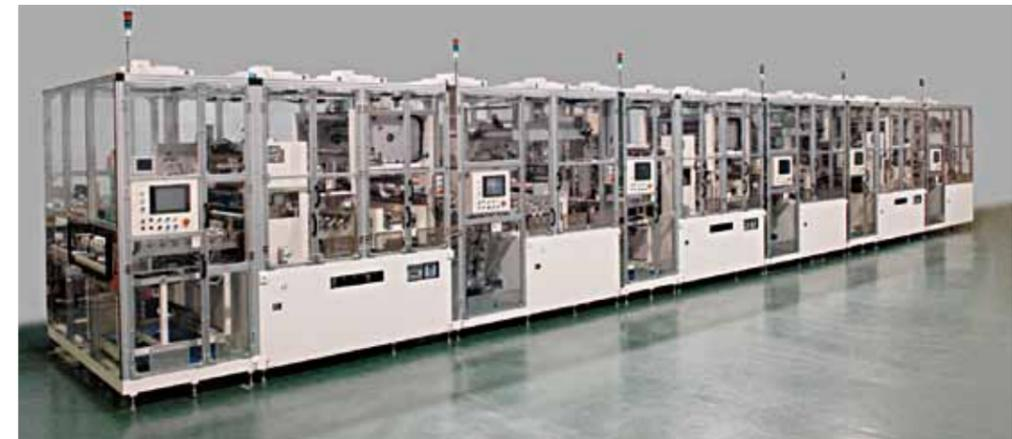
電子ペーパーを製造するための光学系フィルム、保護フィルム、放熱フィルムなどのガラスへの貼り合せに使われるROLL TO SHEET 貼付装置
